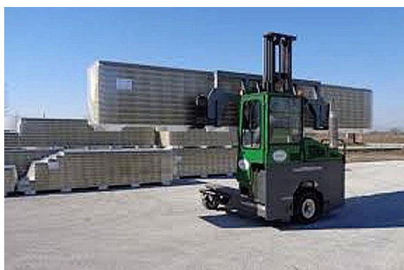
Dimostrazione dello scarico dei pannelli con un caricatore laterale.
