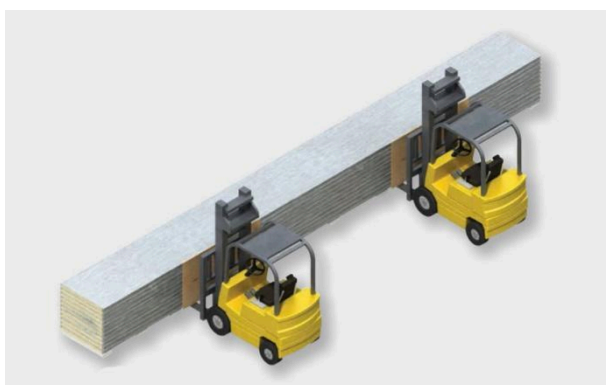
(Dimostrazione dello scarico dei pannelli con due carrelli elevatori)
